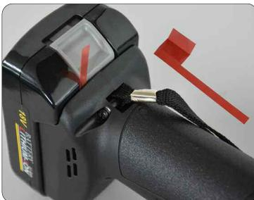
**Bitte den Akku bei Transport und Lagerung vom Gerät trennen, um eine Tiefentladung zu vermeiden!**
