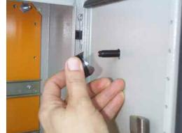
5-Schließen des Ablassventils durch Umlegen des Ablasshebels (andrücken).
