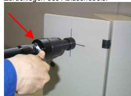
9-Abschrauben der Schneidkrone und Entfernen des Butzens.
