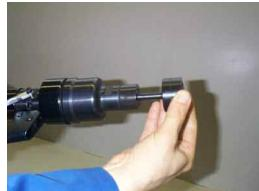
4-Einführung des Zugbolzens in Bohrung, Schneidkrone aufschrauben.
