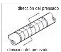
Terminales de presión DIN
